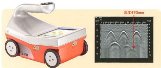
**SIR-EZ HR** 【周波数2600MHz 水平分解能：深度1：水平0.14】
